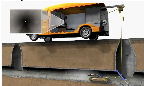
Prinzipdarstellung einer Kanalfemehinspektion mit selbstfahrender Kamera und Inspektionfahrzeug
